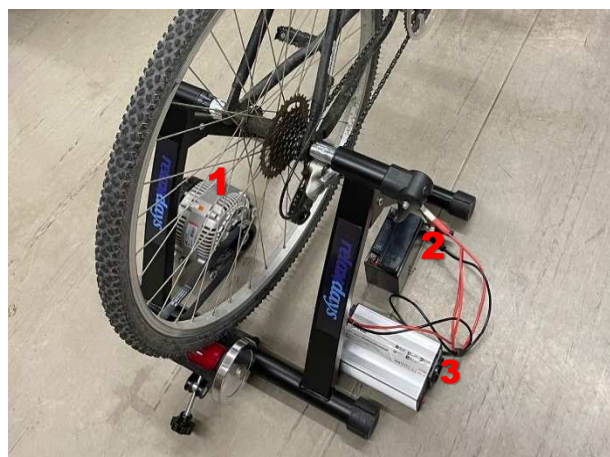
Abbildung 2 Darstellung des Funktionsprinzips mit Systemkomponenten (Endmontage noch in Bearbeitung): 1-Lichtmaschine, 2-Batterie, 3-Wechselrichter
