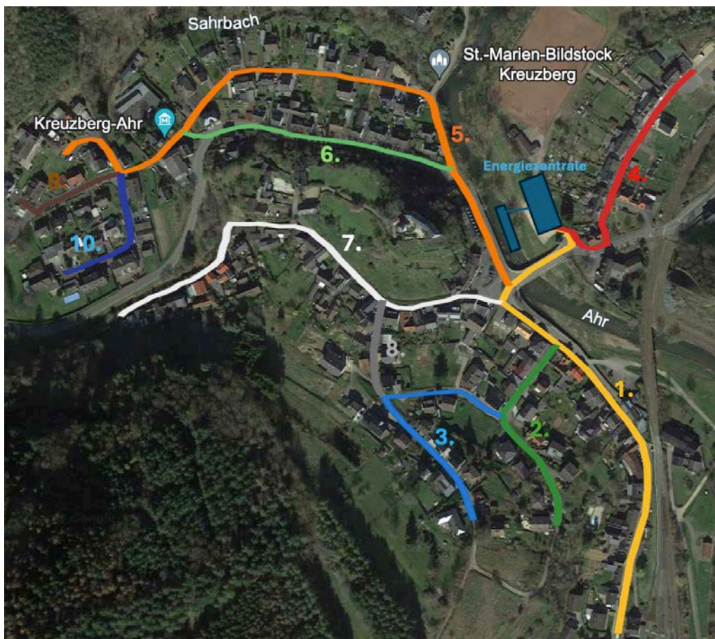
Abbildung 36: Schematische Darstellung des Wärmenetzes inkl. Energiezentrale
