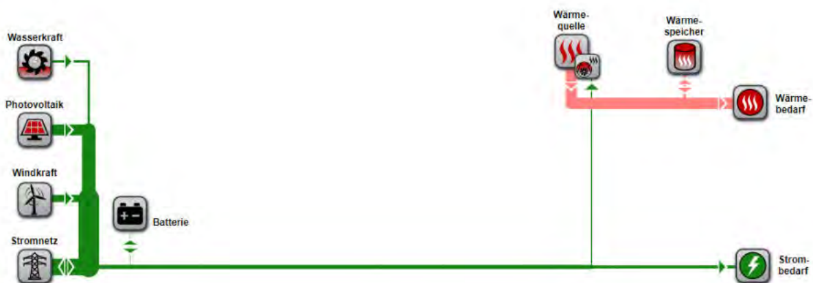
Abbildung 36 Energieflussbild Energiezentrale Variante 4 [37]
