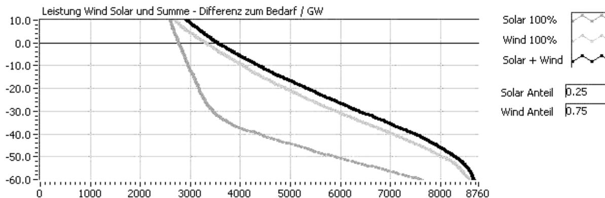
**Bild 3:** Jahrgänge der Differenz zwischen Bedarf und Wind-, Solarenergie und beiden, jeweils skaliert auf 100% des Bedarfs. Nach Daten aus [8].
