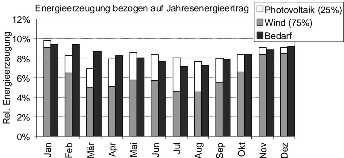
Bild 4: Monatliche Energieerzeugung von Wind-, Solarenergie im Vergleich zum Bedarf, skaliert auf 100% des Jahres-Bedarfs. Nach Daten aus [8].
